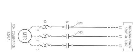
CUSTOMER TO SUPPLY PROPER BRANCH CIRCUIT PROTECTION AS PER LOCAL CODES. (USE 75°C COPPER WIRE ONLY)
