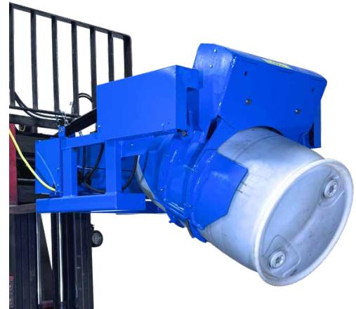
Das Modell 290F wird NICHT für Kunststoff- oder Faserfässer ohne Deckel empfohlen. Wenn bei einem beladenen Fass der Deckel oder der Verschluss fehlt, ist das Modell 290F NICHT zu empfehlen, da die Kunststoffwände des Fasses kollabieren, bevor ausreichend Greifkraft erreicht wird.
