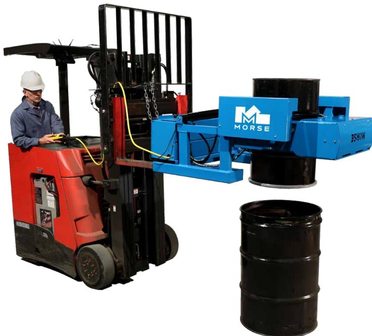
Dieser gabelmontierte Aufsatz verfügt über ein integriertes 12-V-DC-Greif- und Kipp-System, um Trommeln ohne externe Anschlüsse sicher zu greifen und auszugießen. Er passt sich automatisch an Stahltrömmeln mit 36 bis 61 cm Durchmesser (15–55 Gallonen) an und kann mit optionalen Grip Pad Kits für Kunststoff-, Faser- oder Holzfässer ausgestattet werden.
