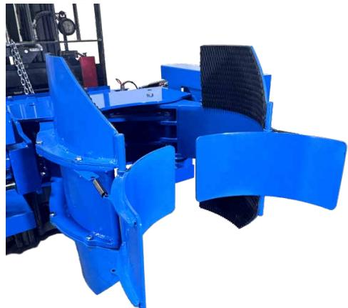
Größere Grip Pads zur Handhabung von Kunststoff- oder Faserfässer bieten 75 % mehr Grifffläche und ermöglichen einen höheren Griffdruck. Die Grifffläche besteht aus einem sehr griffigen SBR-Kautschukpolymer (auch bekannt als RMA-Gummi der Güteklaasse II).
