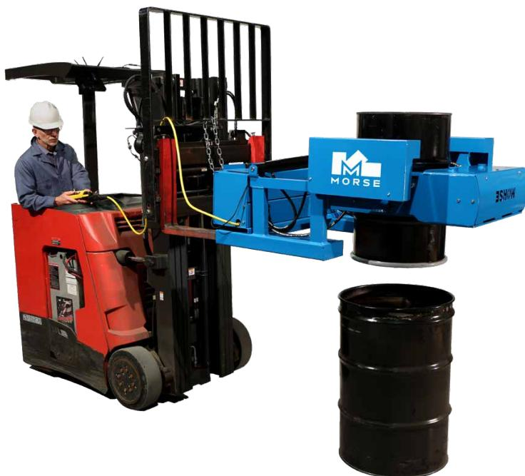
Este accesorio montado en horquilla cuenta con un sistema autónomo de sujeción e inclinación de 12 V<sub>cc</sub> para agarrar y verter bidones sin conexiones externas. Se ajusta automáticamente a bidones de acero de entre 35,56 cm y 60,96 cm (14"-24") de diámetro (15-55 galones) y puede equiparse con kits opcionales de almohadillas antideslizantes para barriles de plástico, fibra o madera.
