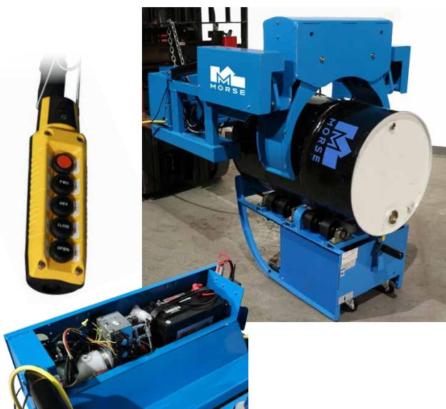
Puede colocar bidones sobre un rodillo para bidones Morse. Después puede levantar el bidón del rodillo cuando se haya terminado de mezclar el contenido.
