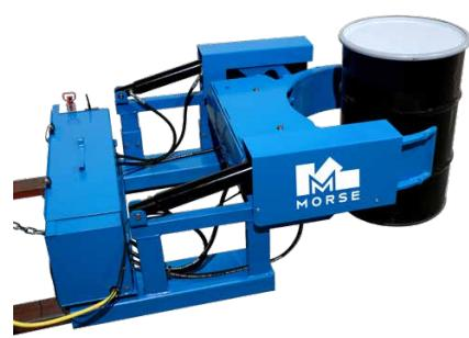
Agarre bidones de un palé, del suelo, de un estante, etc. El bidón se sujetá con mordazas de 20 × 41 cm (8" × 16"). Los cilindros hidráulicos de sujeción de alta resistencia incluyen un fusible de velocidad para proporcionar un cierre total de la línea en caso de fallo.
