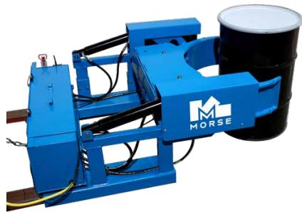
Afferrare un fusto da un pallet, dal pavimento, da uno scaffale, ecc. Afferrare il fusto con ganasce da 20 x 41 cm. I cilindri idraulici di presa per impieghi gravosi sono dotati di un fusibile di velocità per garantire l'arresto completo della linea in caso di guasto.
