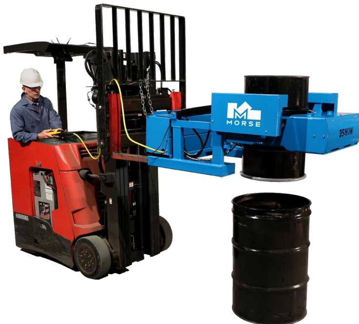
Questo accessorio montato su forche è dotato di un sistema di presa e inclinazione autonomo a 12 V CC per fissare e versare i fusti senza collegamenti esterni. Si adatta automaticamente ai fusti in acciaio di diametro compreso tra 14 e 24 pollici (15-55 galloni) e può essere dotato di kit per cuscinetto di presa opzionali per fusti in plastica, fibra o legno.
