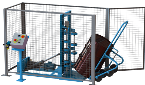
Aufrechtes Fass auf die Grundplatte laden
