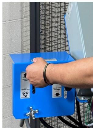
Utilice la palanca ROLL para iniciar la rotación del bidón.
