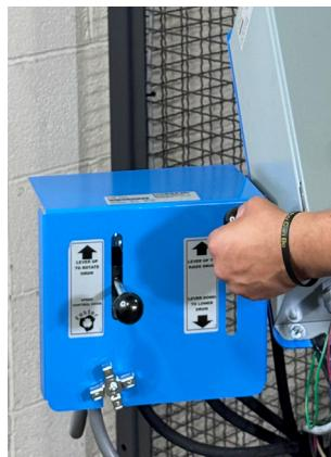
Utilice la palanca TILT para elevar el bidón a la posición de rotación.
