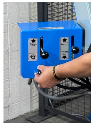
Ajuste la rotación del bidón entre 4 y 16 rev./min.
