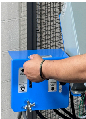
Utilizzare la maniglia ROLL per avviare la rotazione del fusto
