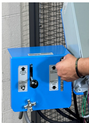
Utilizzare la maniglia TILT per sollevare il fusto in posizione di rotazione
