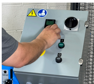
Impostare il timer per far rotolare il fusto per il tempo desiderato, da pochi secondi fino a 16 ore
