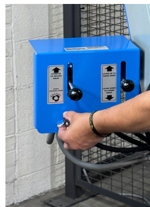
Regolazione della rotazione del fusto da 4 a 16 giri/minuto
