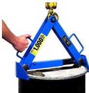
Modelo 92-SS Bidón de 210 l (55 gal.) con asa de elevación de acero inoxidable, diámetro de 45,7-66 cm (18"-26")
