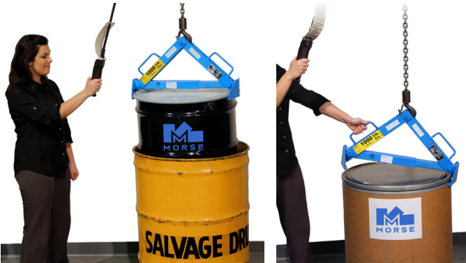
Se engancha bajo el reborde superior. Colocar el bidón en el bidón de recogida.
