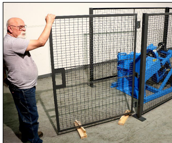
Utilizzare i blocchi distanziatori (non forniti) per sostenere il pannello della porta durante l'installazione.
