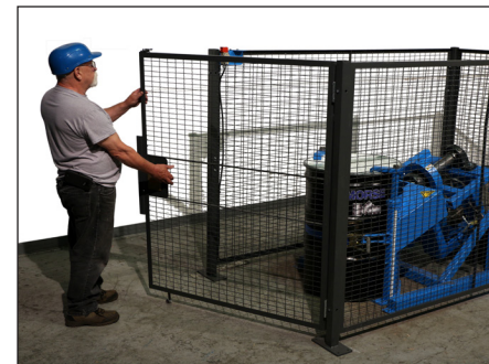
Close door to engage interlock
