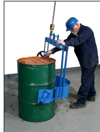
die Kette nicht fest genug am Fass anliegt, heben Sie die Sperrklinke an, um die Kette zu lösen, und probieren Sie es mit einem anderen Kettenglied erneut. Ein fester Handdruck auf den Ratschengriff sollte die Kette ausreichend spannen, um das Fass zu halten. Verwenden Sie keine mechanischen Hilfsmittel, etwa ein Rohr, um den Hebel zu verlängern und dadurch zusätzliche Kraft zu erzeugen.
