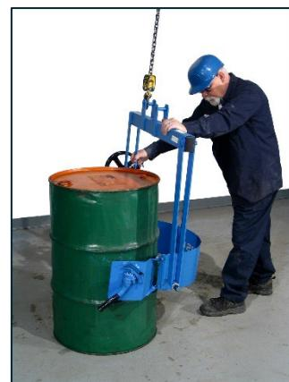
firmemente al bidón, levante el gatillo para aflojar y soltar la cadena e intételo de nuevo con un eslabón diferente en la muesca. Presionando firmemente con la mano sobre el mango del trinquete se debería tensar la cadena lo suficiente para sujetar el bidón. No utilice ayudas mecánicas como un tubo para extender el mango y hacer palanca adicional.
