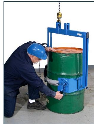
7. Levante el polipasto y coloque el bidón en la estación de vertido.
