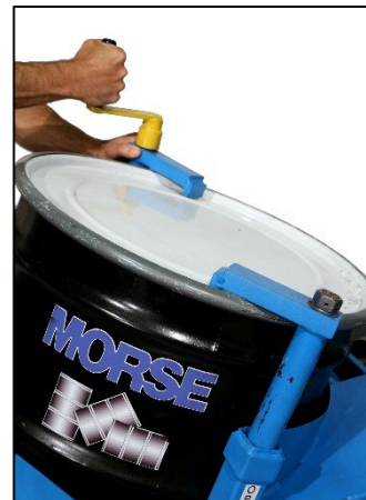
Abbildung 5.5 Drehen Sie die oberen Klammern, bis sie fest an der Oberseite des Fasses anliegen. Entfernen Sie dann die Handkurbel, BEVOR Sie das Fass drehen.
