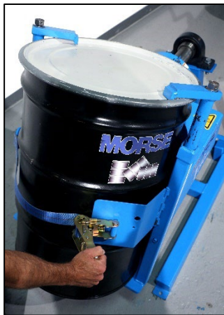
Abbildung 5.4 Legen Sie das Gurtband über das Fass und führen Sie es durch den Schlitz in der Ratsche. Betätigen Sie die Ratsche, um das Band um das Fass zu spannen.
