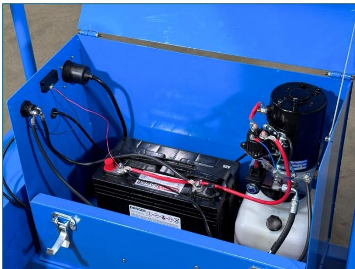
Inspeccione el sistema hidráulico en busca de goteos de aceite, daños en las mangueras u otros signos de desgaste. Inspeccione el nivel y el estado del fluido hidráulico.
