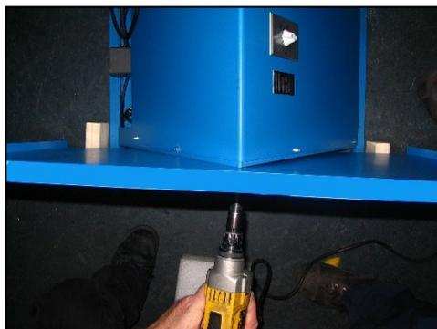
Schritt 8: Schrauben Sie 5 selbstbohrende Schrauben durch die Rückwand in den Winkelrahmen.
