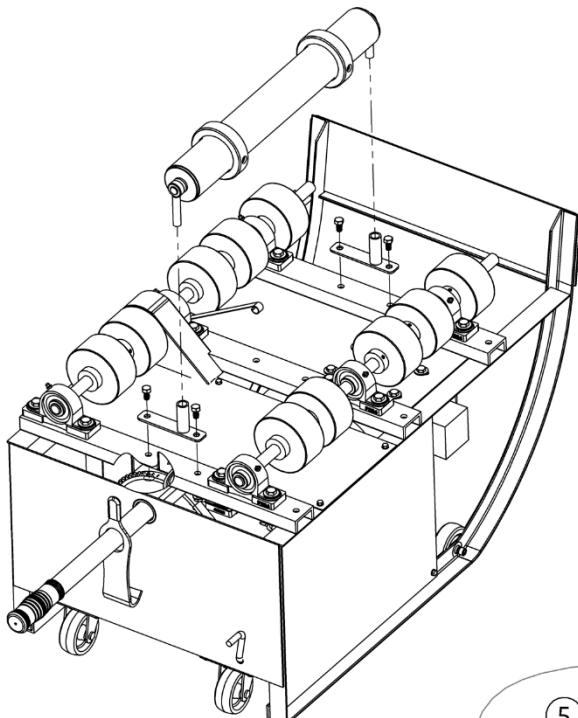
1. Befestigen Sie jeden Rollensockel (Element 1) wie in der Abbildung gezeigt am Rotationskanal. Verwenden Sie die vier mitgelieferten Schrauben (Nr. 7) und vier Schnellverschlussmuttern (Nr. 8).
