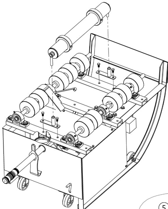
1. Fije cada base de rodillo (elemento 1) en el canal del rotador como se muestra en el diagrama. Utilice los cuatro pernos (elemento 7) y las cuatro tuercas autoblocantes (elemento 8) suministrados.
