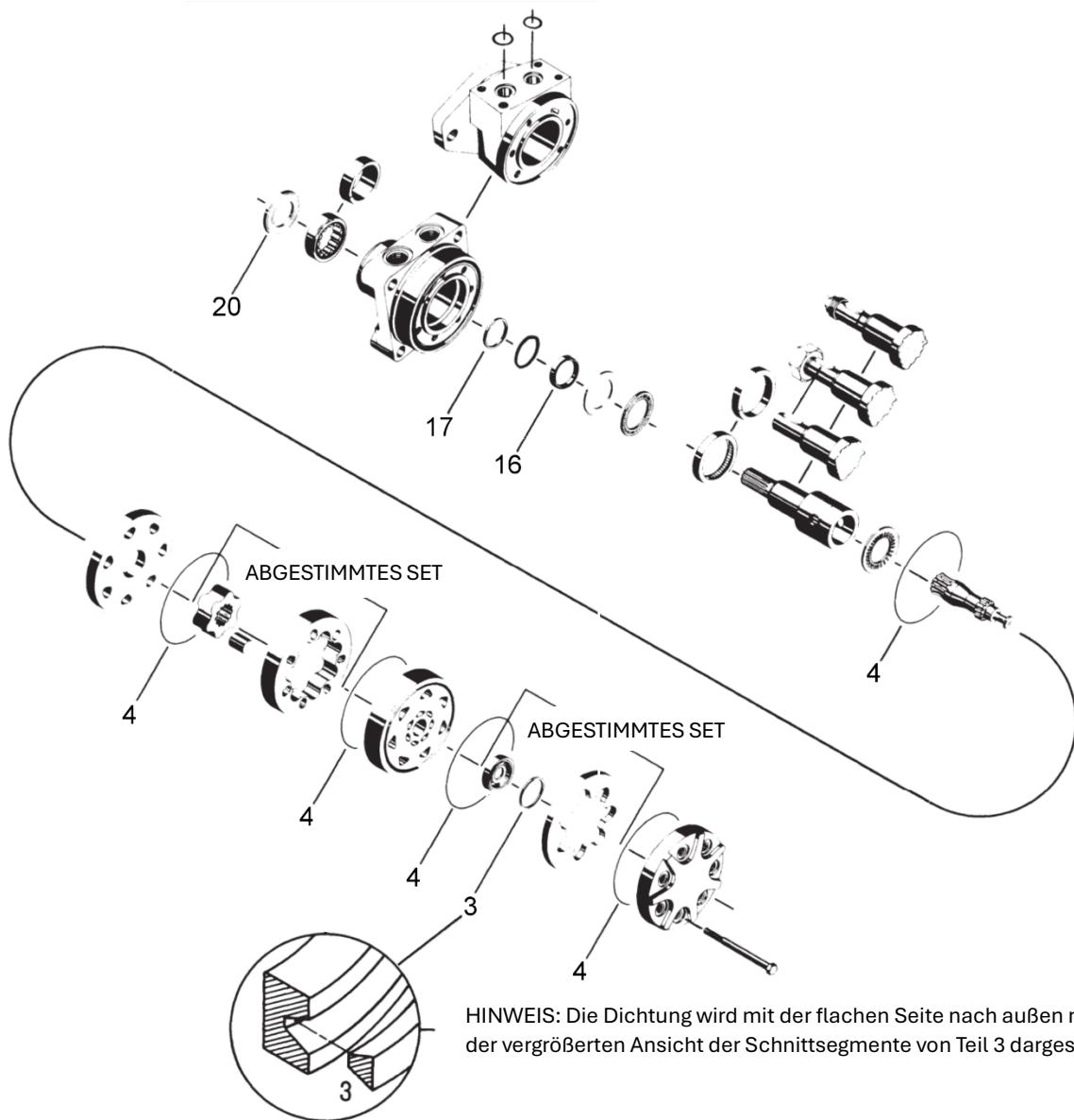
**Der Dichtungssatz 6349-P für die Hydraulikmotoren 6318-P, 6319-P umfasst die folgenden Teile**
