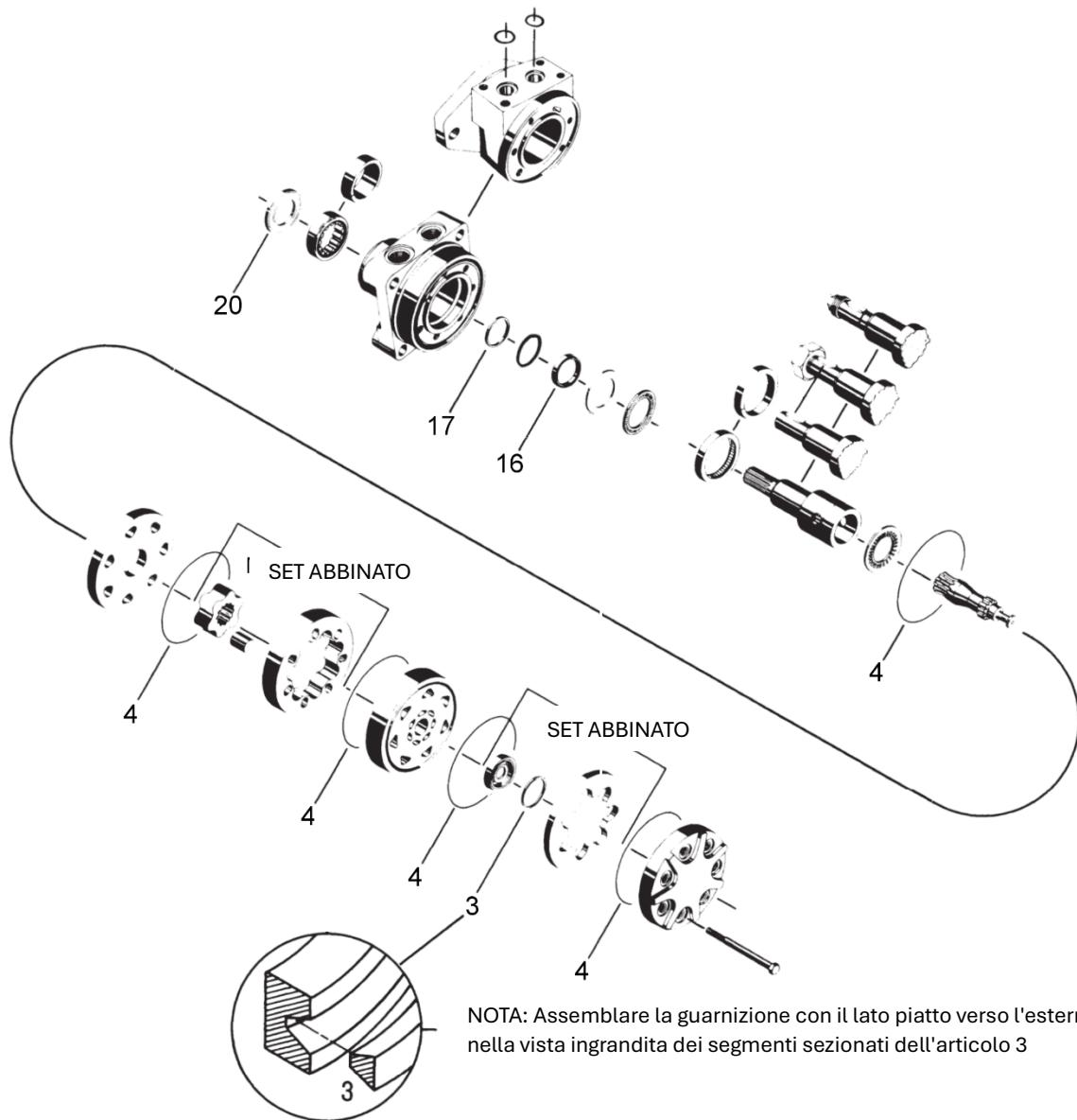
**Il kit di guarnizioni 6349-P per i motori idraulici 6318-P, 6319-P comprende i seguenti componenti**
